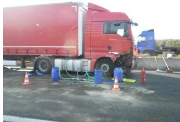
Rettungsarbeiten übernimmt, gilt es danach den Dieselmotorkraftstoff des LKWs umzufüllen und den ausgelaufene Kraftstoff auf der Fahrbahn zu binden und zu entfernen.
